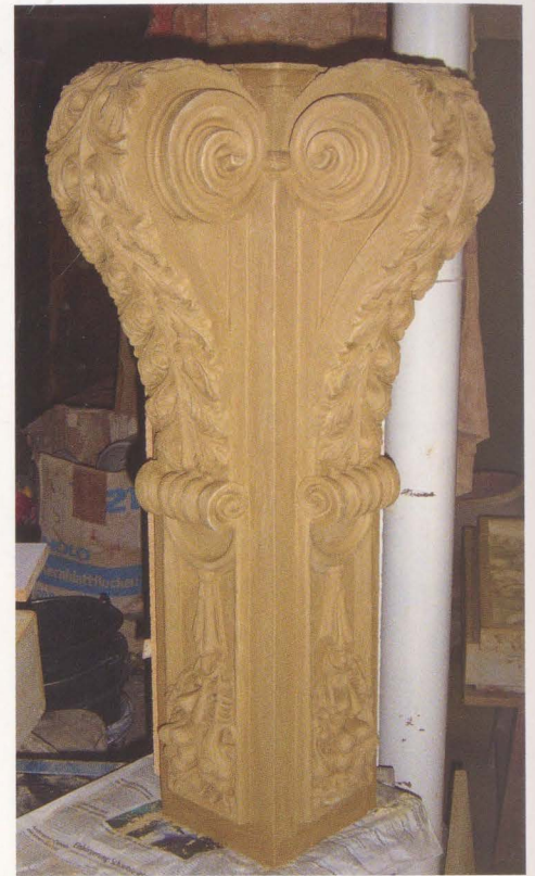
Abb. 6 Zusammengarniertes Eckteil des Unterbaus
