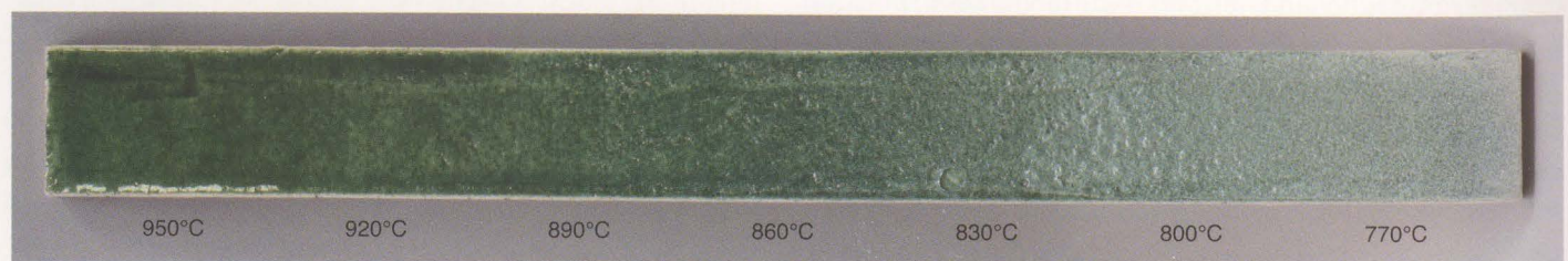
Abb. 3 Glasurveränderung einer Bleiglasur mit dem Temperaturverlauf: bei steigender Temperatur zunehmende Versinterung
