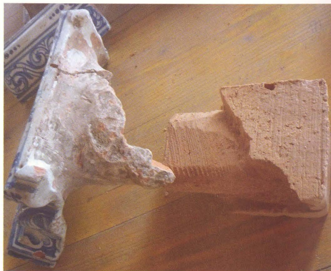
Abb. 4 Kachel aus dem Kranzgesims: Der nur fragmentarisch erhaltene Kachelstumpf wurde mit einem passgenau gearbeiteten Schamottestein unterstützt
