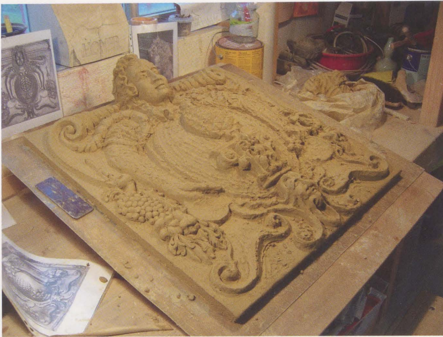
Abb. 5 Modellieren der großen Reliefkachel des Unterbaus
