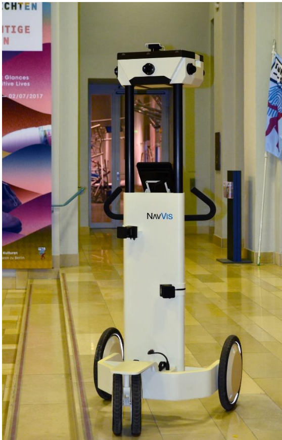
Abb. 1: NavVis M3 Scanrolley vor der Ausstellung
