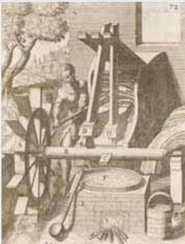
6 · Walkmühle mit Nockenwelle. Illustration aus Böckler 1673, Taf. 72
