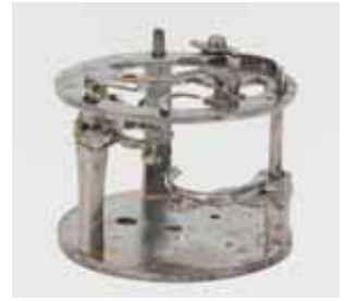
19 · Werksgerüst ohne Räderwerk, Antrieb und Hemmung
