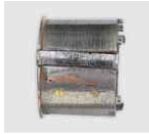
25 · Federhaus mit Keilplatte, Seitenansicht
