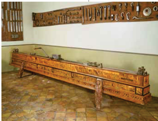
Abb. 4 Drahtziehbank Kurfürst Augusts von Sachsen, Nürnberg, 1565, Nussbaumholz mit Holzmarketerie, Eisen, teils geätzt, in den Tiefen geschwärzt, in den Tiefen geschwärzt. Musée national de la Renaissance, Écouen, Cl. 16880
