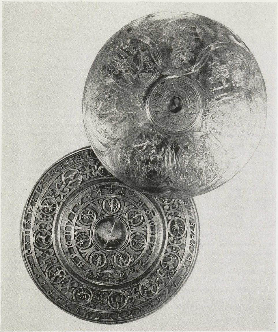
Grubenkompaß mit kleiner Horizontalsonnenuhr und figürlichen Darstellungen von Sonne, Mond und fünf Planeten (Staatl. Math.-Phys. Salon, Dresden — Zwinger)
