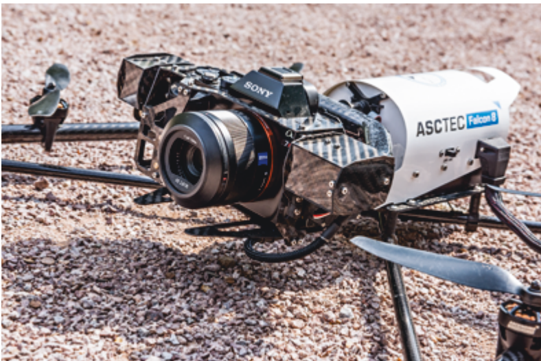
Abb. 1: Ein mit einer gängigen Kamera ausgestattetes unbemanntes Flugsystem (UAS), das von der Professur Modellierung und Simulation– Konstruktion zur Aufnahme von Bauwerken genutzt wird
