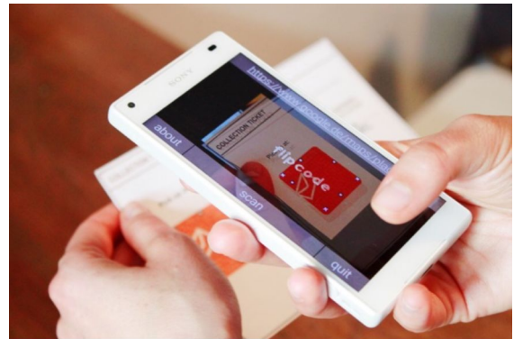
Abb. 3: Android Smartphone-Applikation zum Decodieren der Flipcodes
