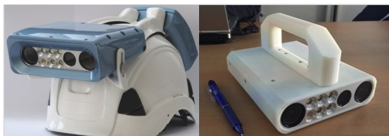
Abbildung 1: Handgetragenes Vermessungssystem IPS.
