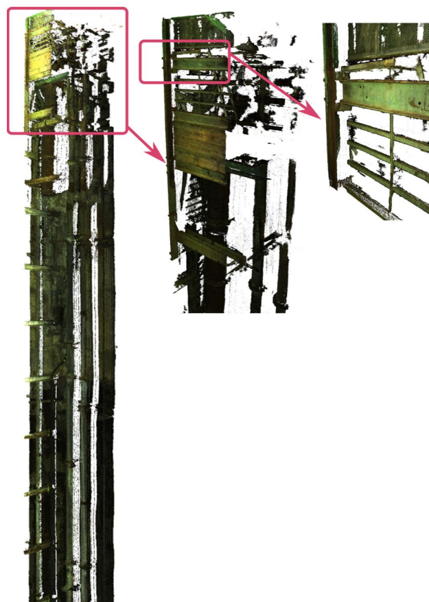
Abbildung 7: Rekonstruktion eines Schachts mithilfe der Offlineprozessierung.
