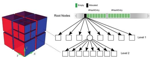
Abbildung 4: Strukturierung der 3D Punkte mit einem "Hashed-Octree".
