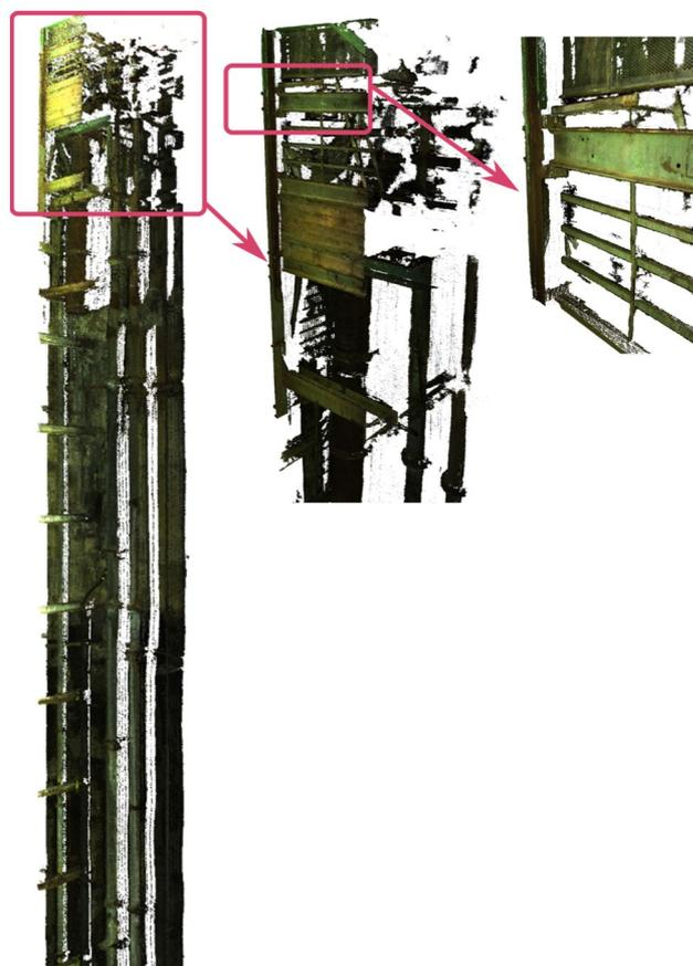
Abbildung 7: Rekonstruktion eines Schachts mithilfe der Offlineprozessierung.
