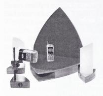
Die neue 3D Scannergeneration unterscheidet sich grundlegend von den bisher üblichen 3D Erfassungs-systemen. Anstelle von "aktiven" Komponenten agieren hier lediglich eine Digital Camera und eine Drehbühne als aufeinander abgestimmte Funktionseinheit.
