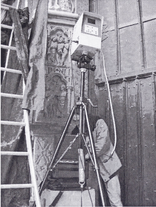
Abb. 1: Minolta VI-700 3D Laserscanner mit Laptop beim Außeneinsatz an der Kathedrale Notre-Dame, Paris
