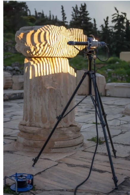
Abb. 3: Scanning in Elefsina, Griechenland, für das PRESIOUS Projekt. Die Säule wurde im Freien gescannt, der Boden ist uneben und der Zugang zur Messstelle erschwert. Die Scanzeit beträgt 4 h mit Auf- und Abbau mit dargetesteten smartSCAN Scanner.
