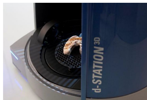
Abb. 4: d-STATION zur automatischen Digitalisierung von kleinen Objekten.
