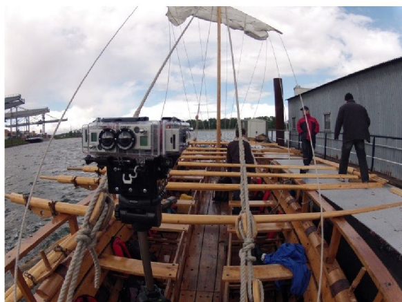
Abb. 13: Erste Version des Eigenbaus eines 360°-Stereo Kameraarrays, bei den von MUFAS/ RGZM und Universität Trier durchgeführten Messungs- und Testfahrten auf dem alten Rhein., 2013
