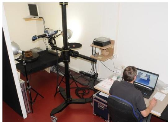
*Abb. 9: Das 3D-Labor im LfA mit Breuckmann smartSCAN-HE, Tageslichtlampen, Lichtzelt und stabiler Rotationseinheit.*
