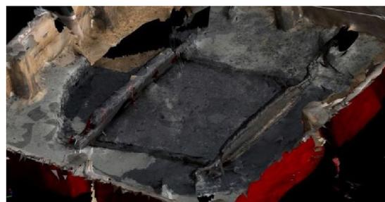
*Abb. 5: Durch die für den terrestrischen Laserscanner ungünstigen Aufnahmebedingungen lückenhaftes und fehlerbehaftetes 3D-Modell.*
