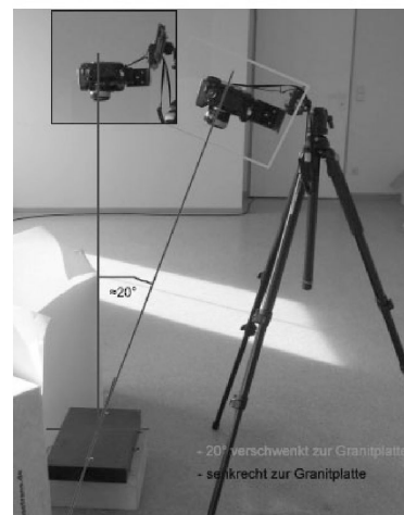
Abb. 7: Aufnahmeanordnung (senkrecht und 20° verschwenkt zur Platte)
