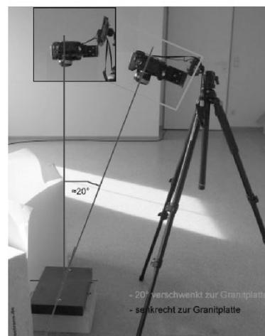
Abb. 7: Aufnahmeanordnung (senkrecht und 20° verschwenkt zur Platte)
