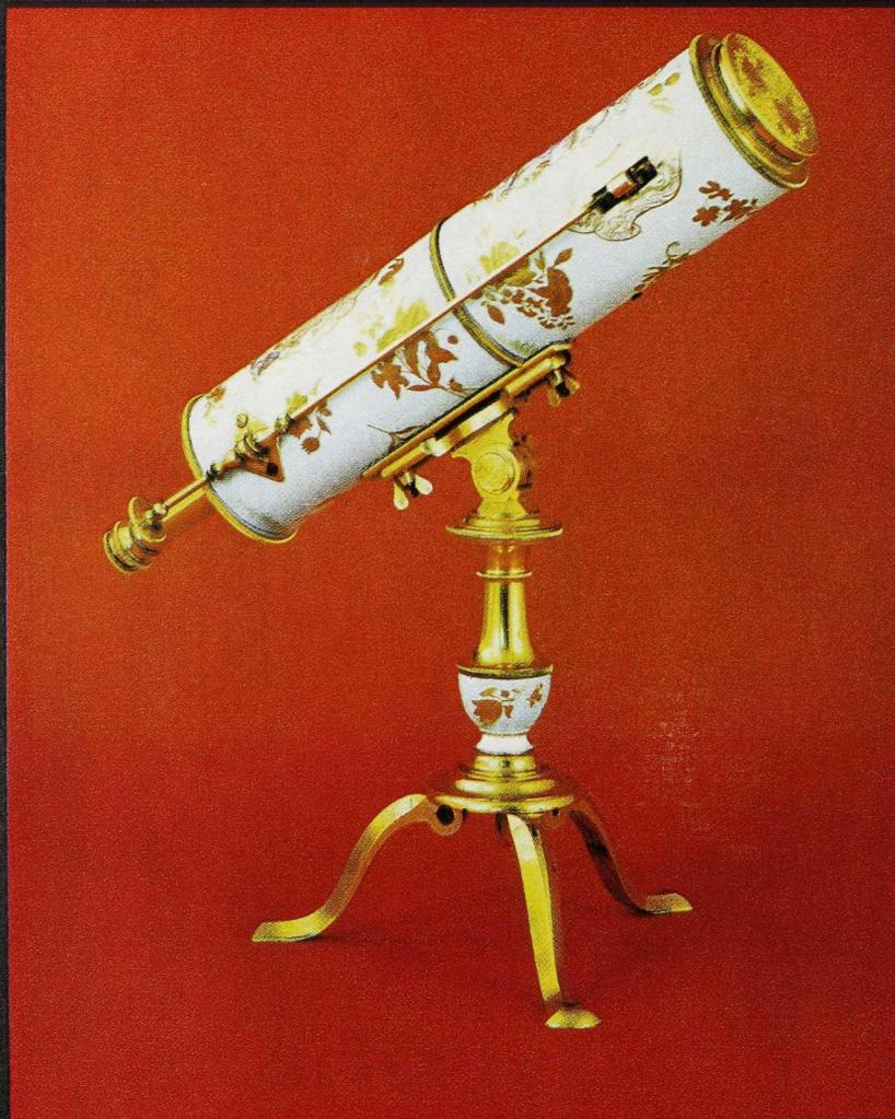
Staubschutz-Schraubkappe des Hauptrohres
