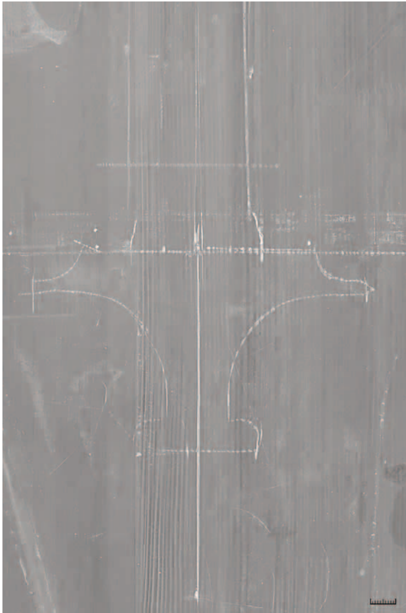
Abb. 71 Kat.4, Gm1055, Röntgenaufnahme, Detail der geritzten Kontur einer Architekturkonsole: Spuren der Längenübertragung mit Hilfe eines Zirkels
