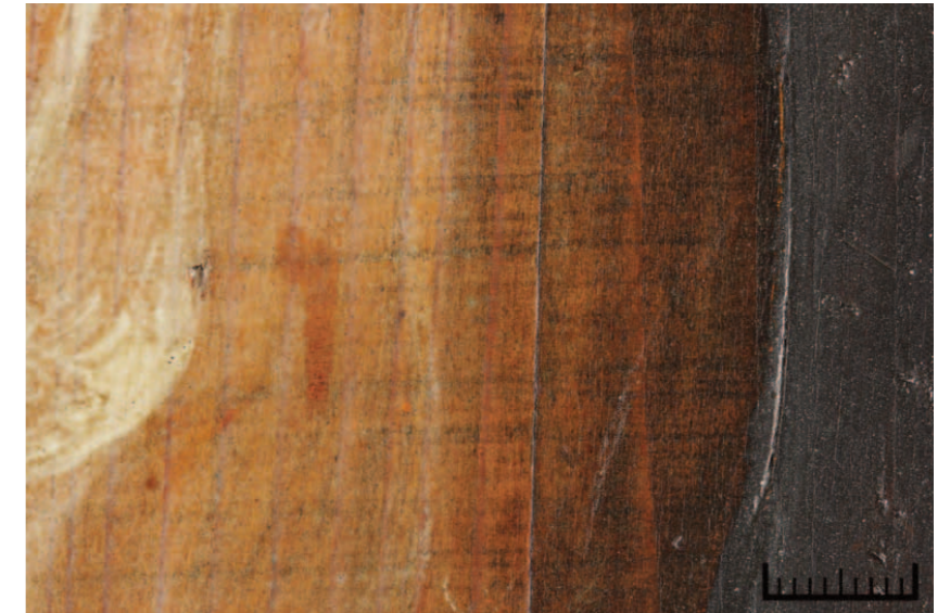
Abb. 89 Kat.4, Gm1055, Vorderseite, Detail am Lendentuch des linken Schächers: horizontal verlaufende, graue Streifen in den Holzporen des Bildträgers
