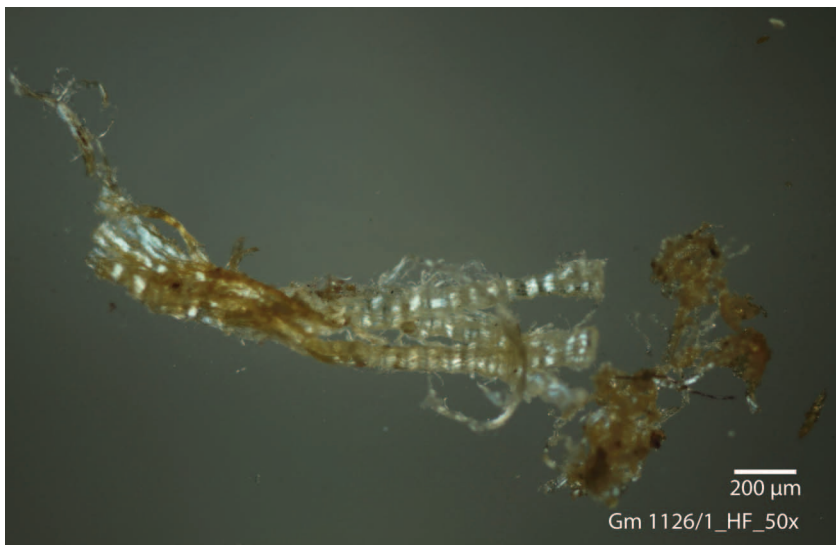
Abb. 36 Kat.10, Gm1126, Faserprobe der Kaschierung der Vorderseite, lichtmikroskopische Aufnahme, a (oben) einfach polarisiertes Licht, b (unten) gekreuzte Polarisatoren
