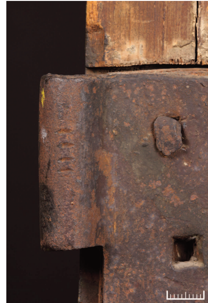
Abb. 28 Kat.22, Pl.O. 147, Rahmung, Detail der Scharnieröse: Markierung mit vier horizontal eingeschlagenen Strichen
