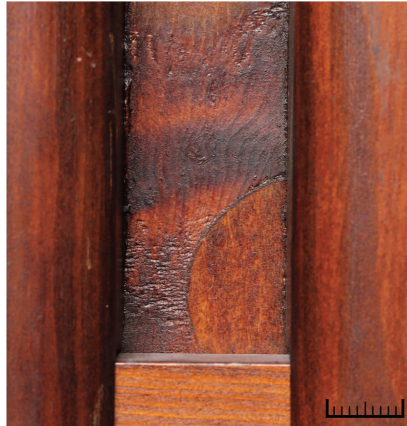
Abb. 26 Kat.20, Gm1180, parkettierte und gedünnte Rückseite, Detail: Intarsie
