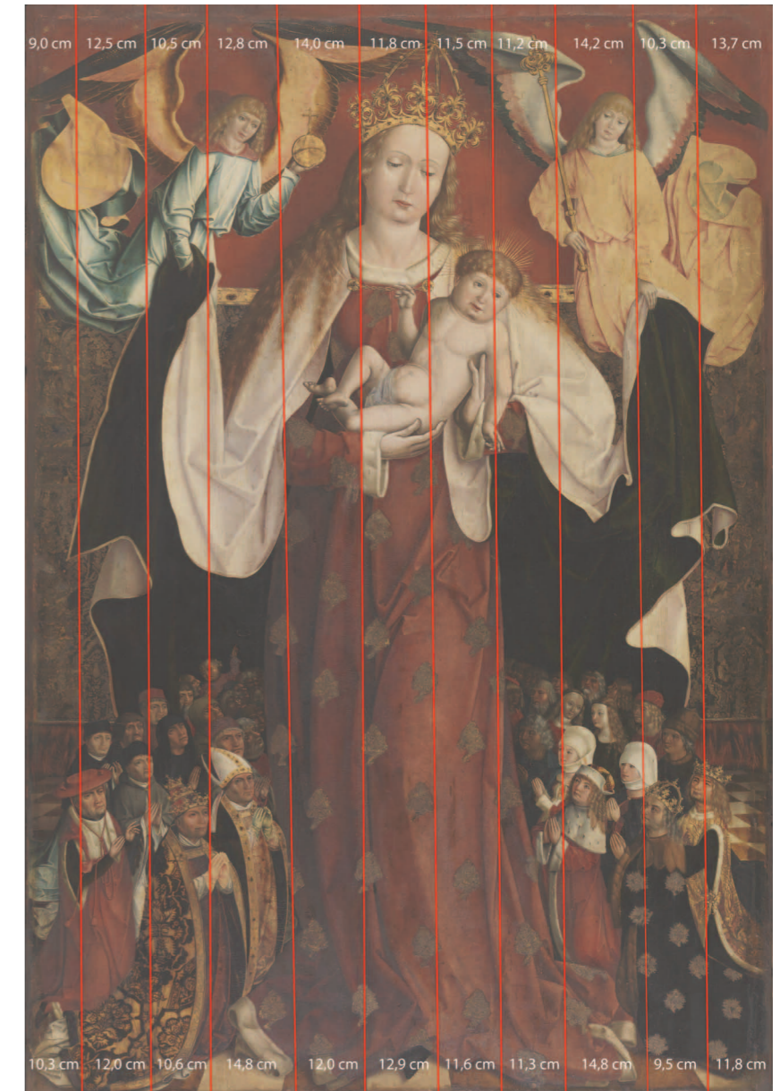
Abb. 6 Kat.11, Gm1067, Kartierung der Tafelfügung
