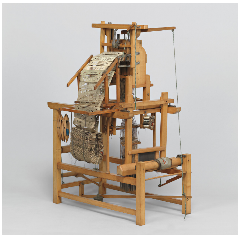
76) Funktionsmodell eines Jacquard-Webstuhls, 1860er Jahre, Kat. 76
