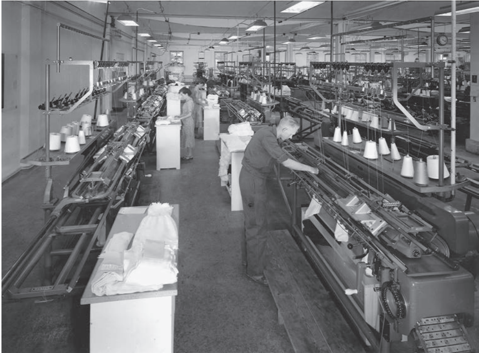
Abb. 23 Blick in den Saal der Flachstrickerei, vermutlich um 1959. In der rechten unteren Ecke des Bildes ist die Lochkarte aus Stahl zu sehen, die die Nadeln steuert, wodurch das Strickmuster entsteht. Die Stahlkarten wurden nicht in der Hanro AG gestanzt, sondern bei den Maschinenherstellern in Auftrag gegeben. Das Resultat war also unbekannt. Deswegen gibt es zahlreiche Ordner mit sogenannten „Probierqualitäten“ im Archiv.
