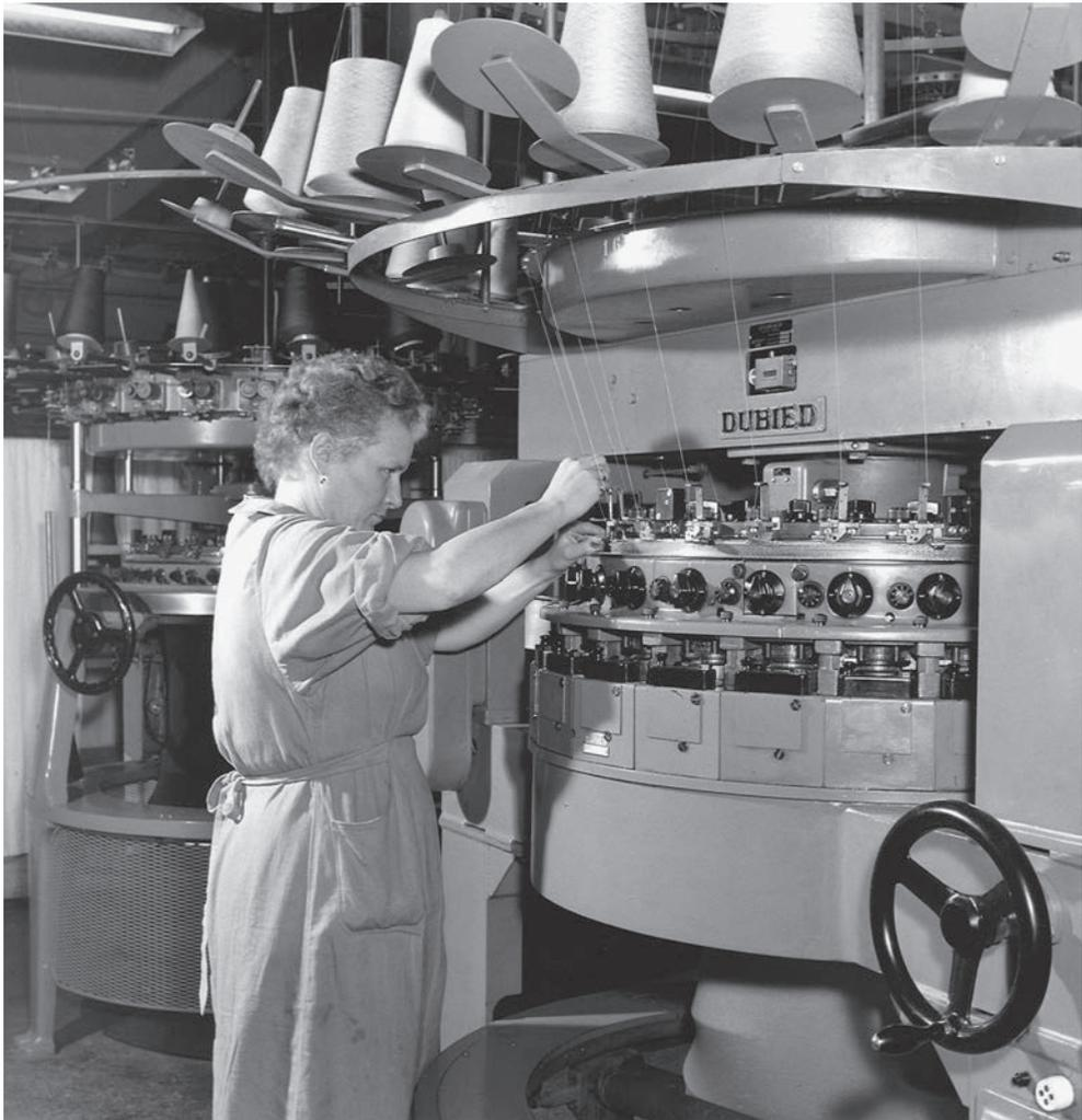
**Abb. 24** Arbeiterin zieht Faden an einer Großrundstrickmaschine ein, vermutlich um 1959.
