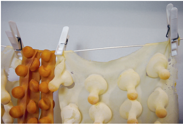
Abb. 8 Ermüdungsrisse an unter mechanischer Belastung gealterten Naturlatexhäuten, Foto: Martina Pfenninger Lepage
