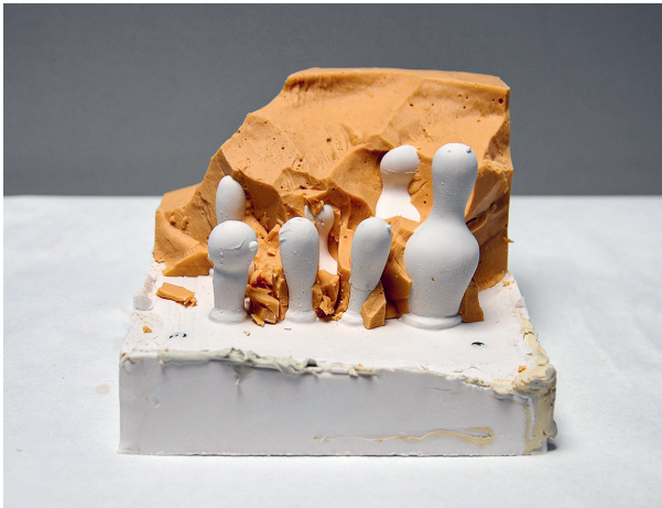
Abb. 10 Entformen eines Zwischenpositivs aus Hartgips zur manuellen Bearbeitung der Oberfläche, Abnahme der Negativform aus Alginat, Foto: Lea Huck
